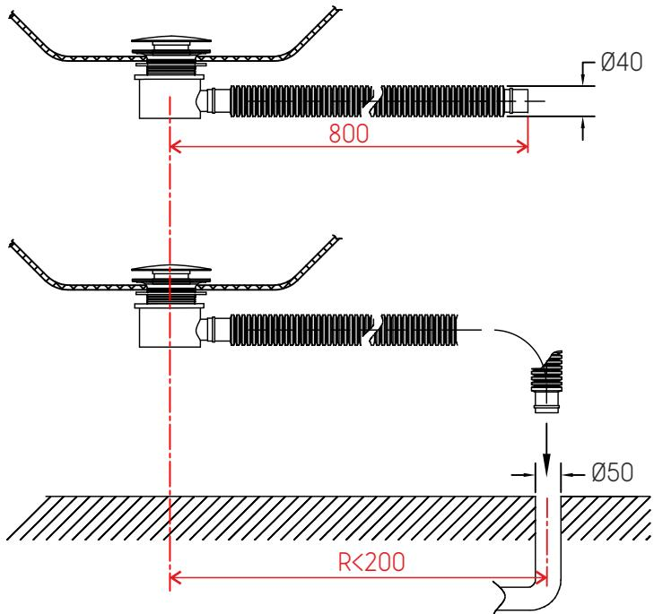
**NL** Dit bad heeft geen overloop en dient alleen te worden geïnstalleerd in een badkamer met een aparte afvoer in de vloer. Verlaat niet uw badkamer als u het bad gaat vullen om te voorkomen dat het bad gaat overlopen.
